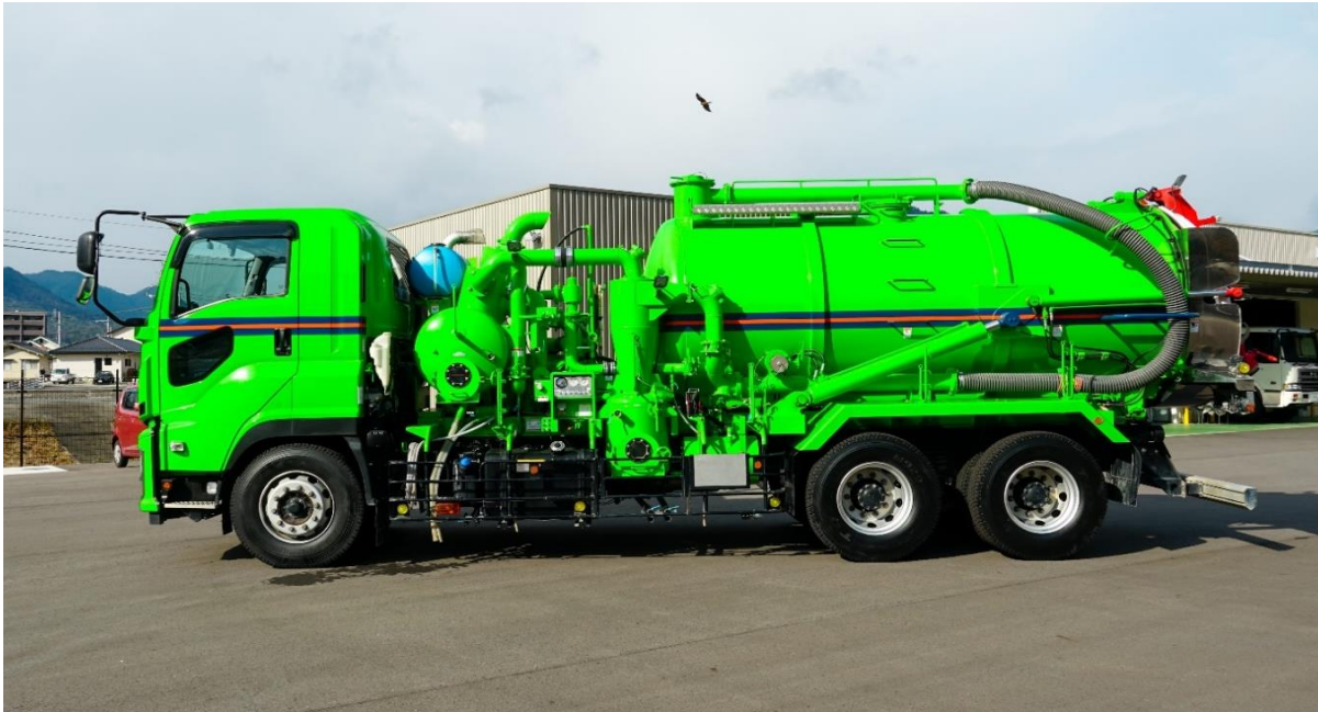
大型強力吸引車 積載:8,950kg 風量:40m 3 /min
