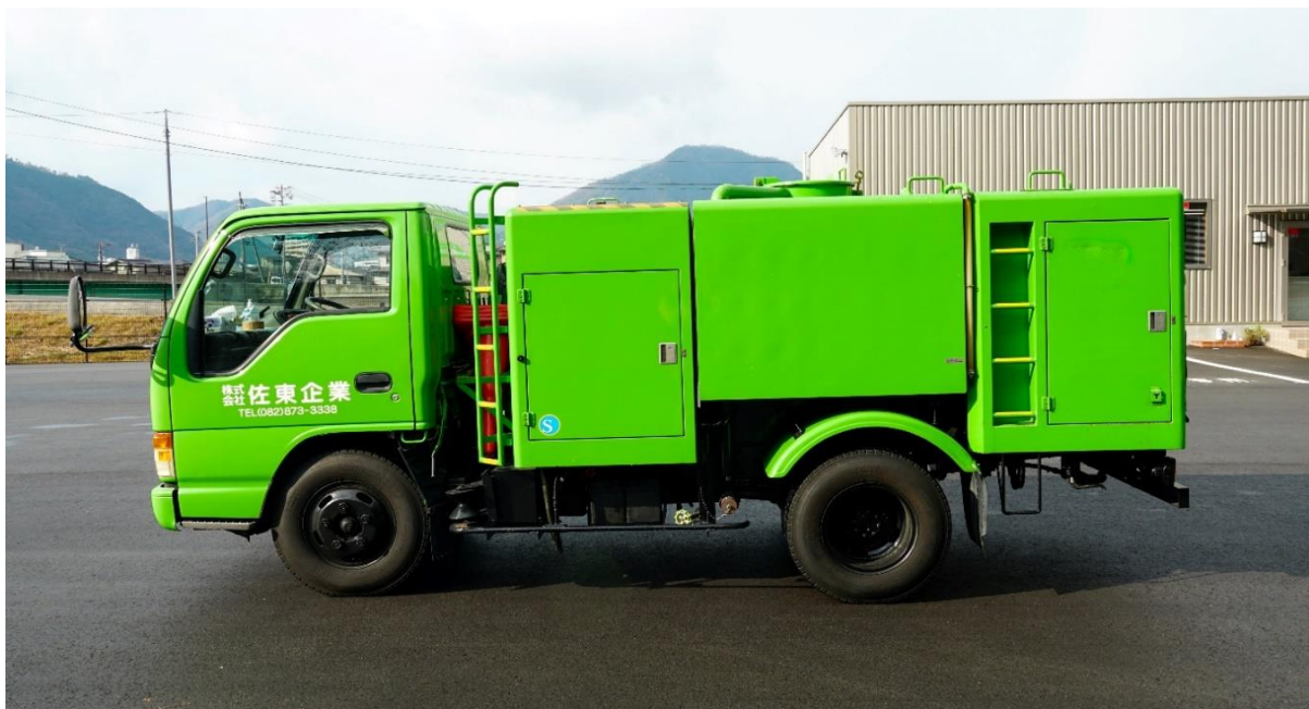
高压洗浄車 積載:2,000L(水) 圧力:110kg/cm 2 吐出量:135L/min
