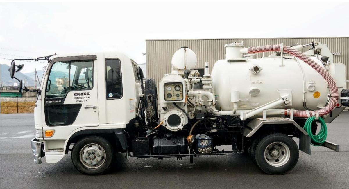
4t強力吸引車 積載:2,600kg 風量:20m 3 /min
